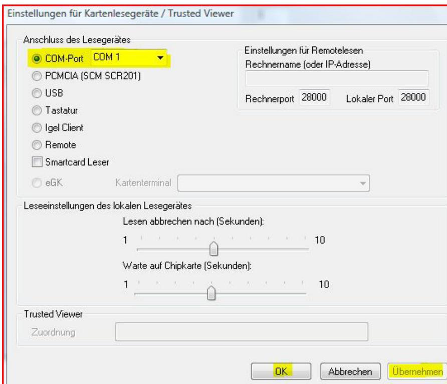
Bei *Port* tragen Sie den COM-Port ein, an welchem das Gerät angeschlossen ist, meist COM1.
